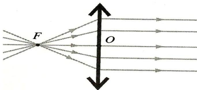
**Pour une lentille convergente, les foyers principaux objet et image sont symétriques par rapport au centre optique. Le foyer objet est situé avant le centre optique et le foyer image après  $O$  dans le sens de propagation de la lumière.**
