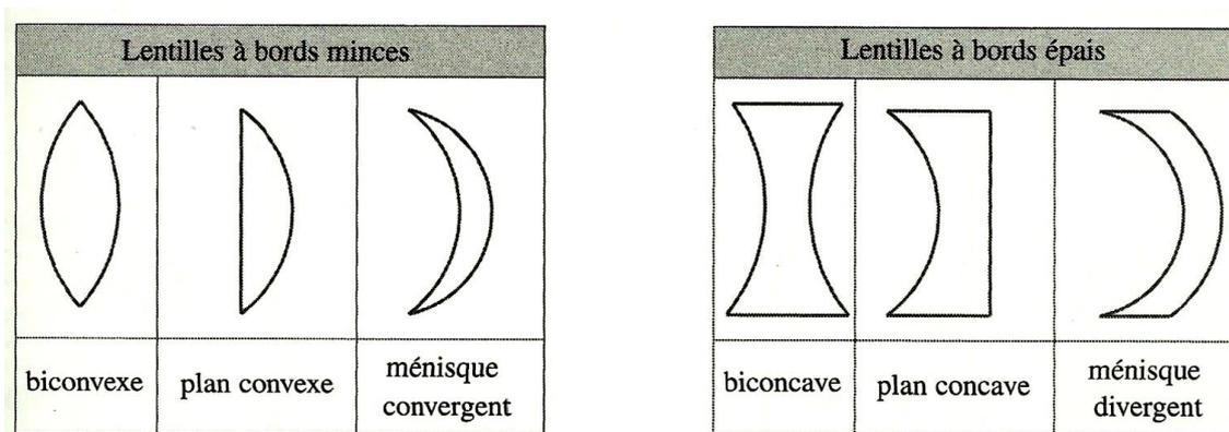
Dans les conditions normales d'utilisation de la lentille, il existe un point  $O$  situé sur l'axe optique, tel que pour tout rayon passant par  $O$  à l'intérieur de la lentille, le rayon sortant de la lentille est parallèle au rayon entrant. Ce point est appelé centre optique de la lentille.
