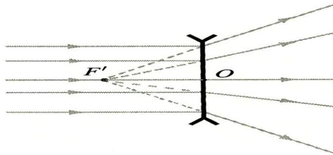
Si l'on éclaire la lentille par un faisceau convergent dont les prolongements de rayon se croisent au point symétrique de  $F'$  par rapport à la lentille, le faisceau émergent est parallèle à l'axe. Ce point est donc le foyer principal objet  $F$ . C'est un point objet virtuel.
