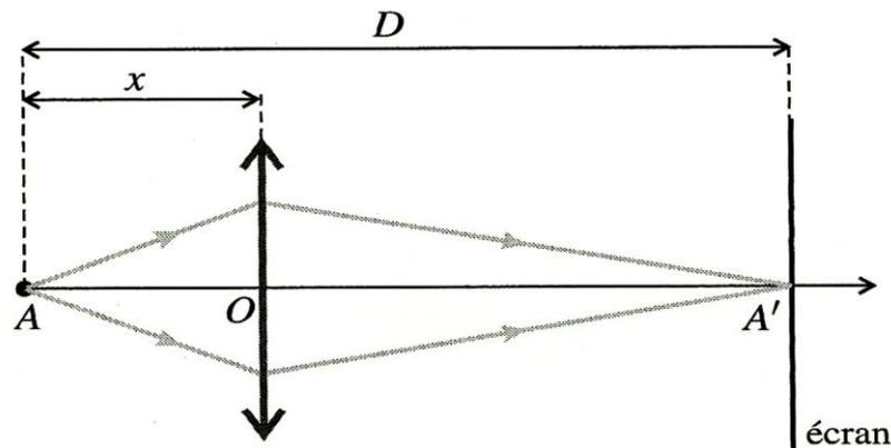
Pour projeter un objet sur un écran avec une lentille convergente, il faut que la distance  $D$  entre l'objet et l'écran et la distance focale image  $f'$  de la lentille vérifient :
