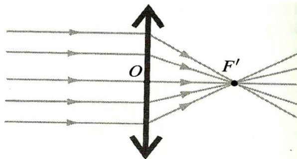
De même si l'on place une source ponctuelle au point  $F$  symétrique de  $F'$  par rapport à  $O$ , on observe qu'après la lentille, le faisceau est parallèle à l'axe donc  $F$  est le foyer principal objet.
