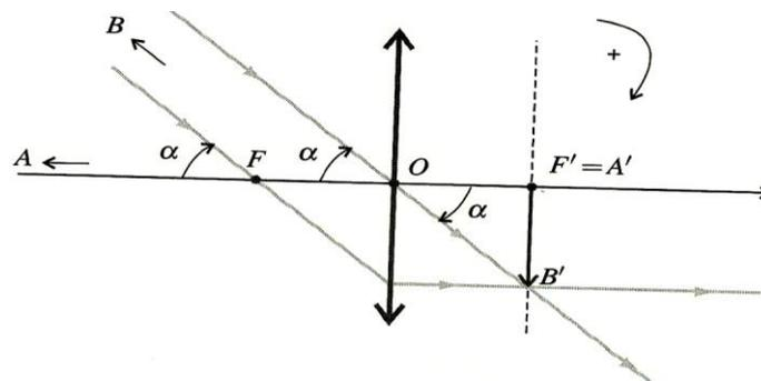
**Résultat :** un objet à l'infini a une image réelle, dans le plan focal image.
