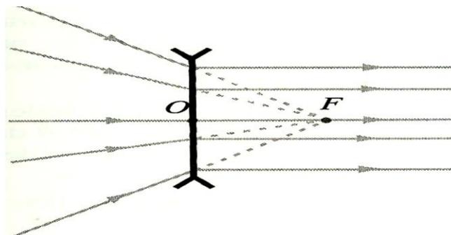
**Pour une lentille divergente les foyers principaux objet et image sont symétriques par rapport au centre optique. Ce sont des points virtuels : le foyer objet est situé après le centre optique et le foyer image avant  $O$  dans le sens de propagation de la lumière.**
